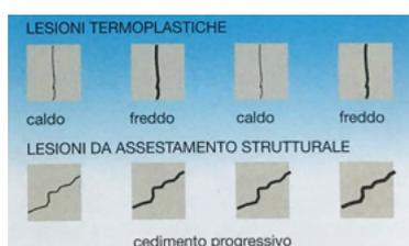
Figura 5.2 lesioni termoplastiche e lesioni da assestamento.<sup>e</sup>
