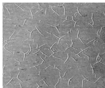
**Figura 5** screpolatura a zampe di gallina (crow's foot cracking)
