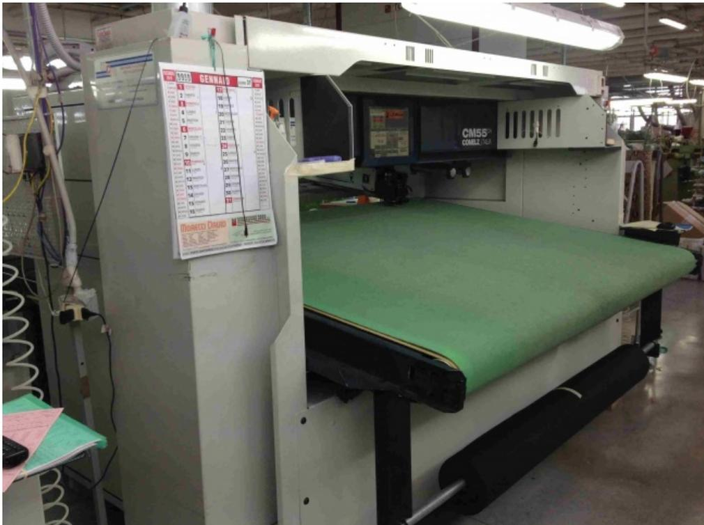
*Figura 1. Macchina Comelz per il taglio automatico del pellame*
