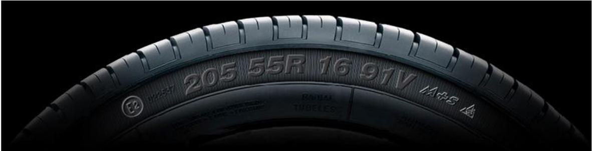
*Figura 2.8 Sigle sulla spalla dello pneumatico*
