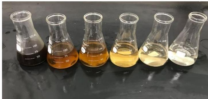
**Figura 3.4** *Soluzione ottenuta sciacquando le fibre con acqua distillata dopo diversi passaggi a pH decrescente*
