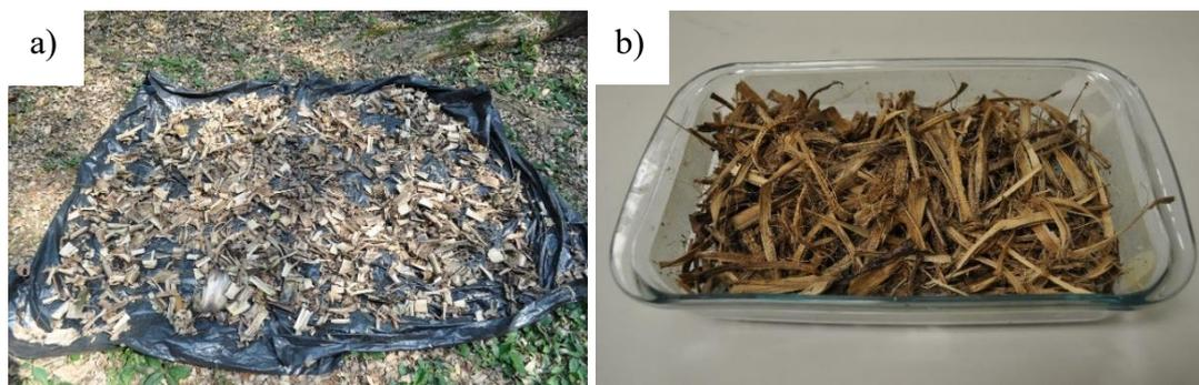
*Figura 3.2 Essiccamento all'aria aperta delle fibre naturali: a) fibre distese sul telo all'aria aperta; b) fibre essiccate dopo dieci giorni*
