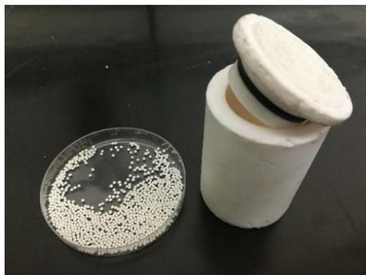
*Figura 3.8 Sfere di zirconia e contenitore in Teflon® utilizzate nel ball milling*
