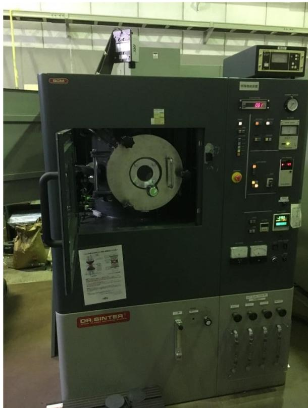
*Figura 2.1: SPS Dr. Sinter 1050 prodotta da Sumitomo Coal Mining Co., LTD. in uso presso il NIMS.*
