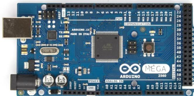
Fig. 6-1 Scheda Arduino Mega 2560 utilizzata per l'automatizzazione
