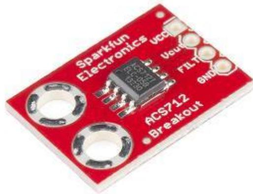
**Figura 4-1 Sensore di corrente - Effetto Hall - ACS 712 [18]**
