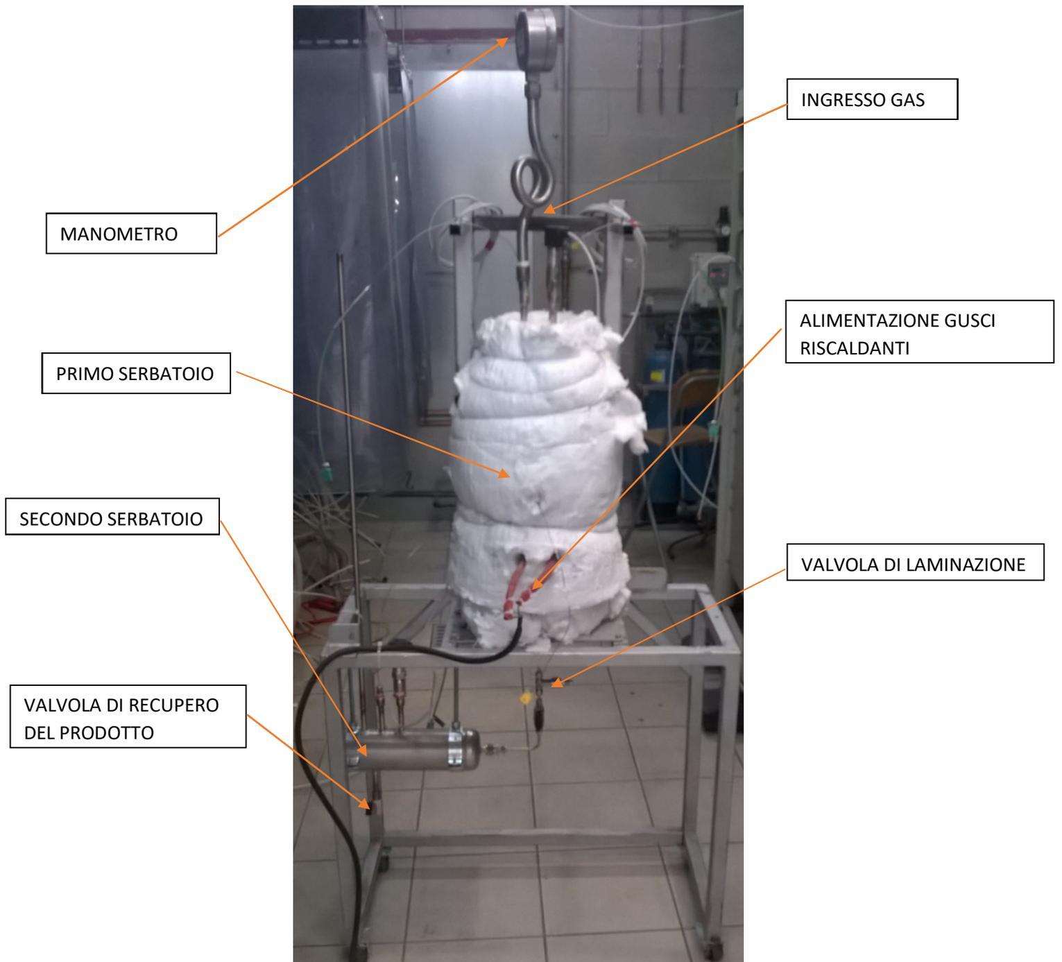
**Figura 4.2.:** *L'apparato sperimentale di CELBICON nella sua configurazione finale.*
