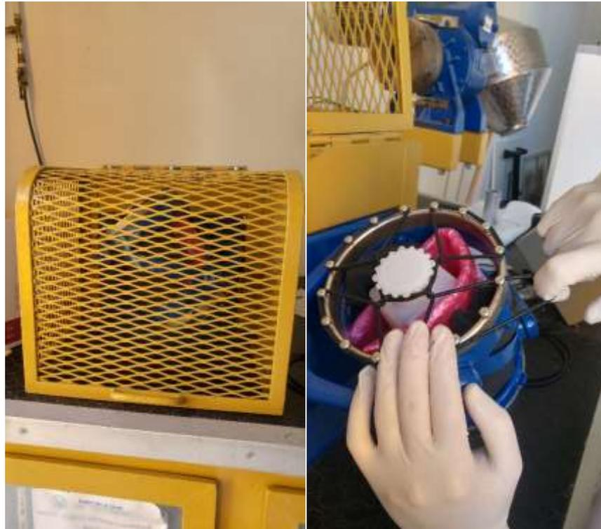
*Fig 53 Turbula con dettaglio del posizionamento di un contenitore*
