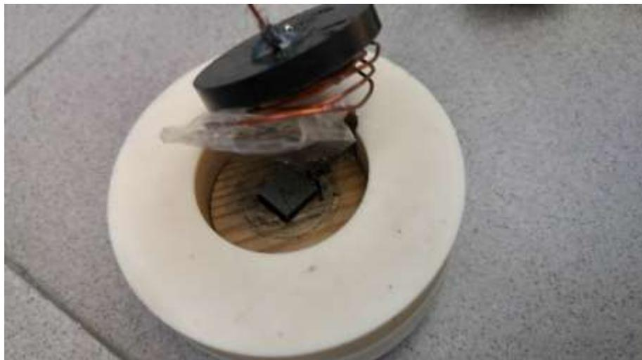
*Fig 72 Campione posto dentro la bobina*
