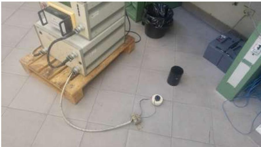
*Fig 73 Bobina collegata al magnetizzatore*
