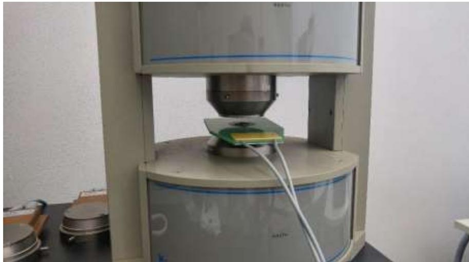
*Fig 81 Misuratore con polo sollevato e campione in posizione*
