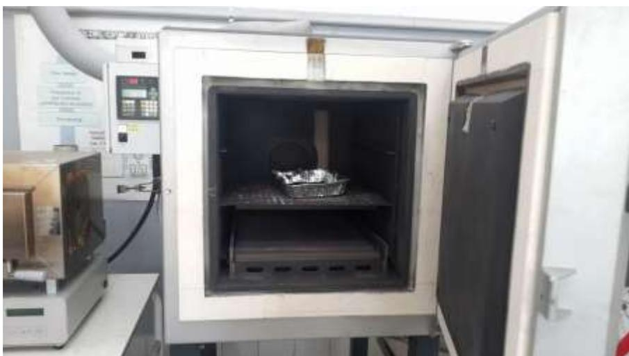
Fig 63 Campioni inseriti nel forno
