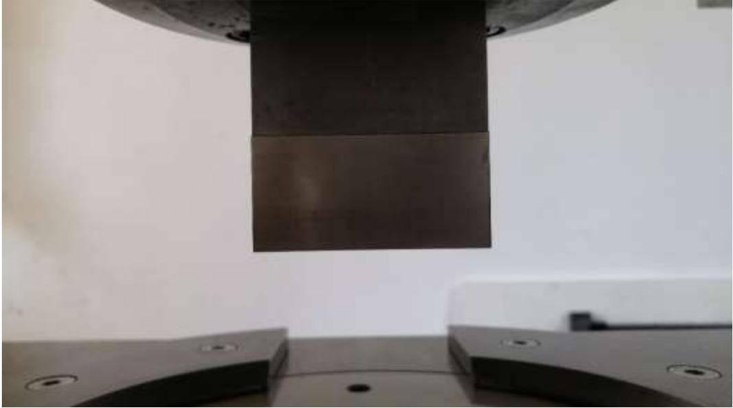
*Fig 56 Dettaglio del punzone superiore in posizione*
