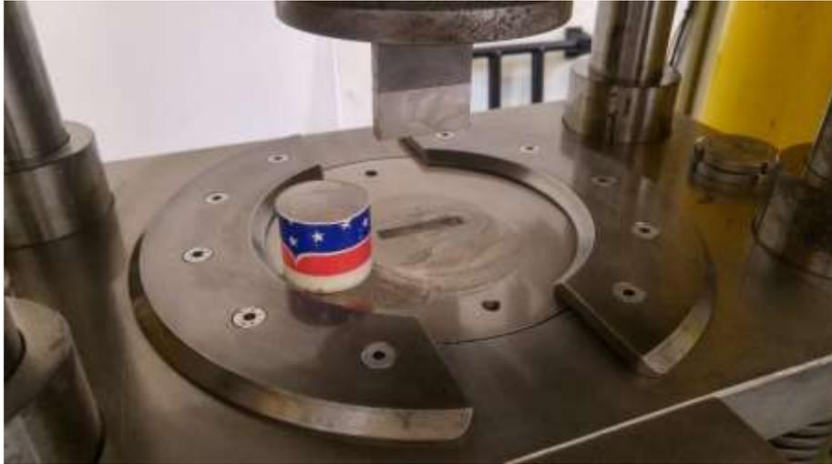
*Fig 58 Camera riempita con la polvere, a fianco il dosatore*
