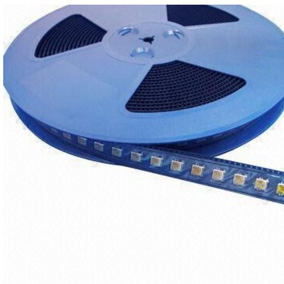
Figura 4.21: Packaging a bobina di componenti SMD
