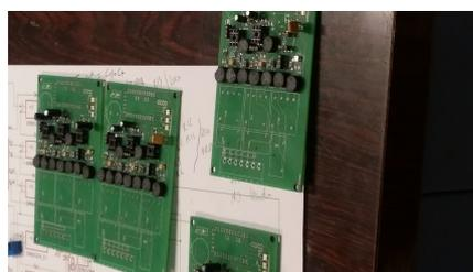
(b) Inizio saldatura componenti through-hole
