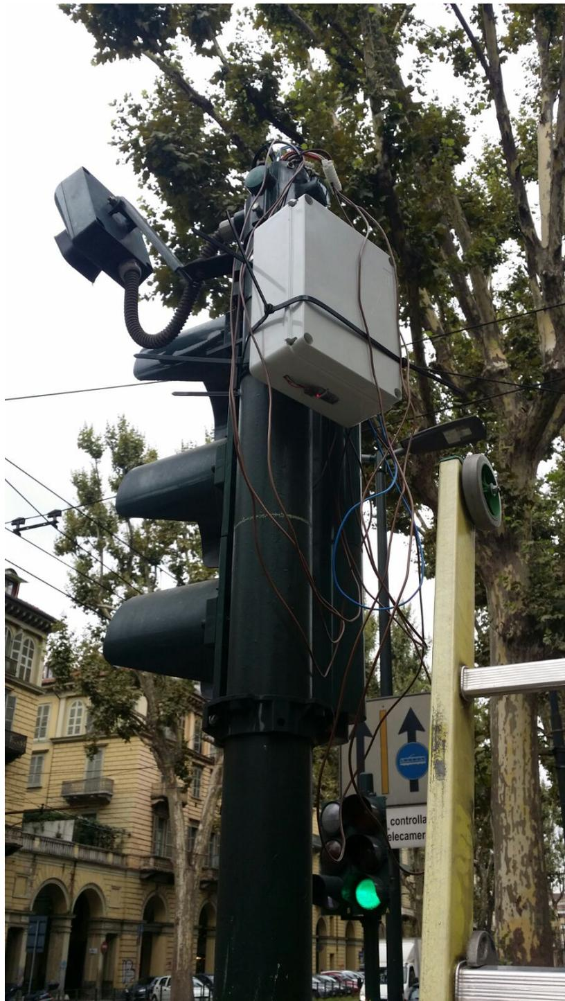
Figura 3.2: Posizionamento del primo prototipo BLE sulla lanterna semaforica
