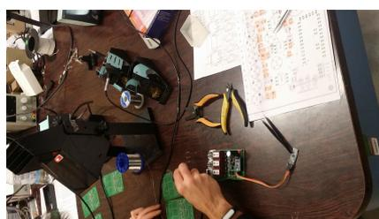
(d) Processo di saldatura su PCB
