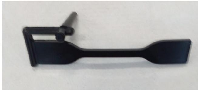
**Figura 3.3:** Forma di un provino di HDPE caricato per prove di trazione ottenuto per stampaggio a iniezione, con ancora attaccato il canale di iniezione.
