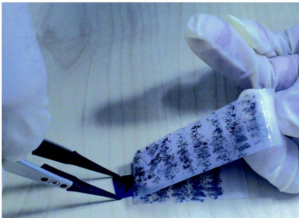
**Figura 2.12:** Sintesi del grafene a partire da un blocchetto di grafite mediante metodo scotch tape [17].
