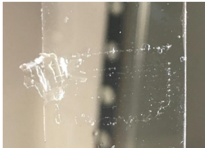
Figura 3.18: Distacco completo del coating di FD su vetrino non trattato in seguito alla prima incisione del cross-cut test.
