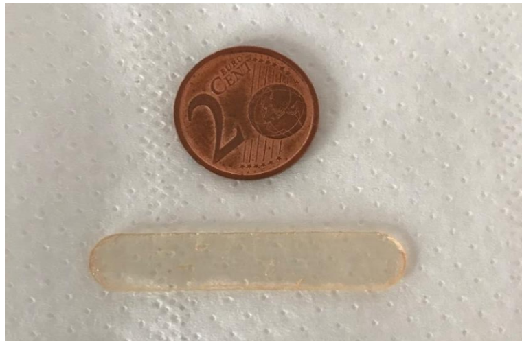
Figura 2.11: Campione per prova di resistenza normale.
