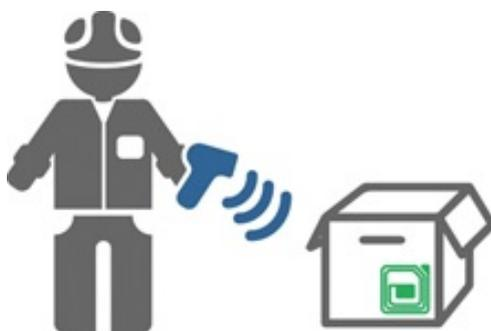
Figura 1.6: Funzionamento di un lettore RFID: l'etichetta contiene un'informazione e il lettore la legge.
