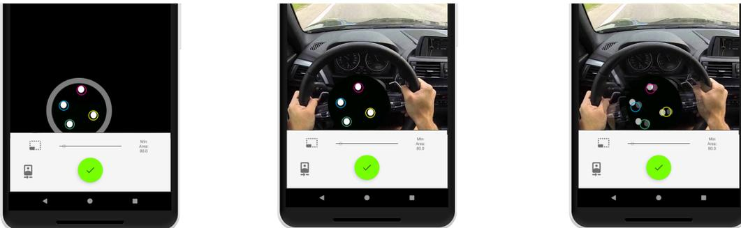
Figura 6.22. Le ultime due figure rappresentano l'interfaccia utente: nel momento in cui lo sterzo verrà ruotato i marker verranno *seguiti* dall'algoritmo e quindi cerchiati come identificati.
