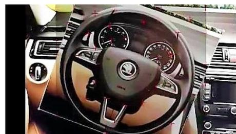
Figura 4.3. Condizione di angolo di  $40^\circ$ , l'algoritmo continua a "seguire" i punti nonostante la diversa rotazione
