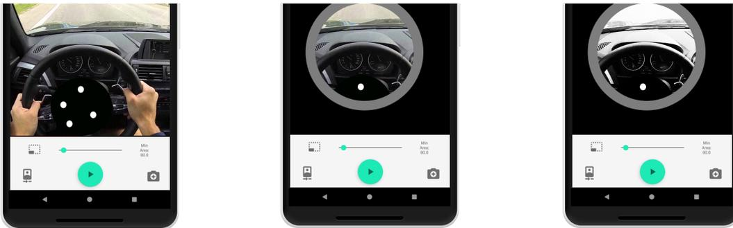
Figura 6.19. L'immagine iniziale viene "croppata" utilizzando il riferimento della *ROI* e successivamente convertita.
