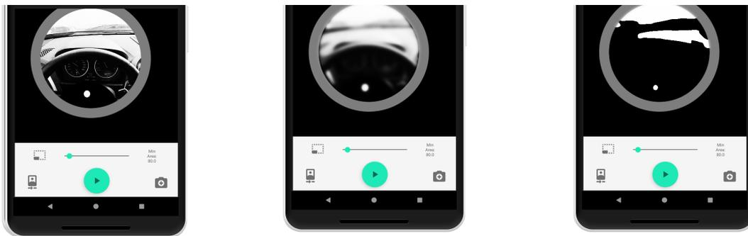
Figura 6.20. Il frame subisce delle trasformazioni per ridurre al minimo il rumore ed infine viene applicata la funzione *soglia*.
