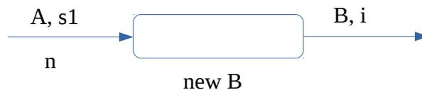
un altro tipo di pattern corrisponde ad un mapping task: riceve un'entità e il relativo stato in input e restituisce un'altra entità con il relativo stato in output; l'entità restituita è legata all'entità di input attraverso una qualche relazione tramite il quale viene effettuato il mapping (corrispondenza):
