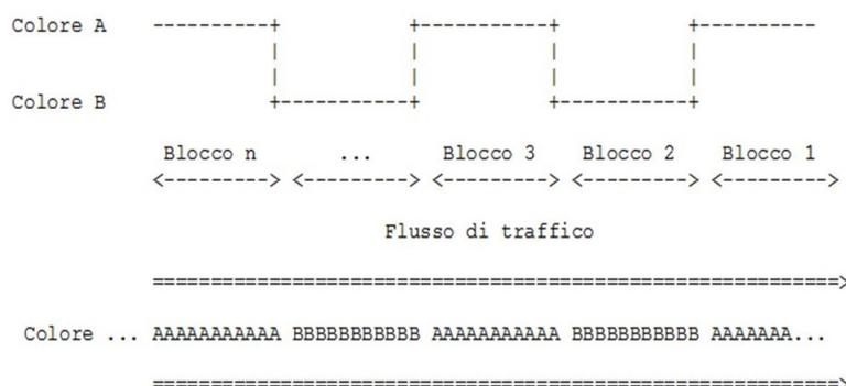
Figura 4.3: Applicazione del metodo PNPM per calcolare la perdita di pacchetti sul link.
