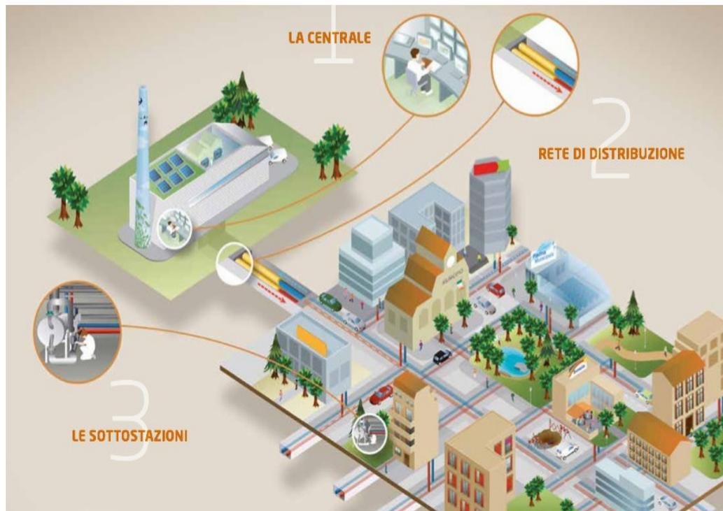
Figura 10: Schema generale di un impianto per il teleriscaldamento (18)
