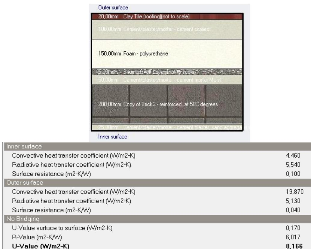
Figura 38: stratigrafia solaio di copertura con isolamento a schiuma poliuretana e tabella con relative caratteristiche
