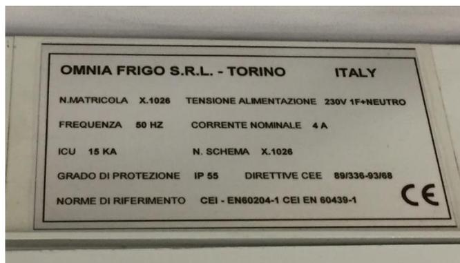
Figura 4-3. Dati tecnici della camera climatica Omnia Frigo.
