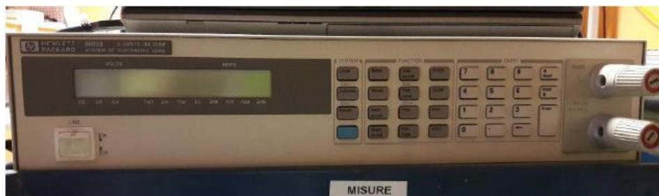
Figura 3-7. Carico elettronico variabile 6063B.
