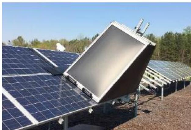
Figura 3-25. Cofano per l'acquisizione di immagini EL sul campo.
