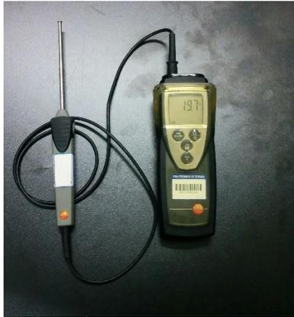
Figura 3-3. Termometro utilizzato per la misura della temperatura ambiente.
