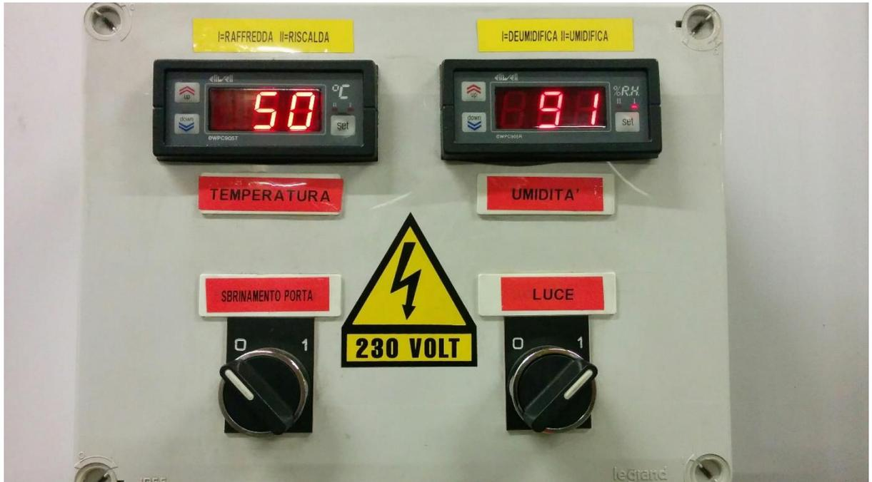
Figura 4-4. Pannello di controllo della camera climatica Omnia Frigo.
