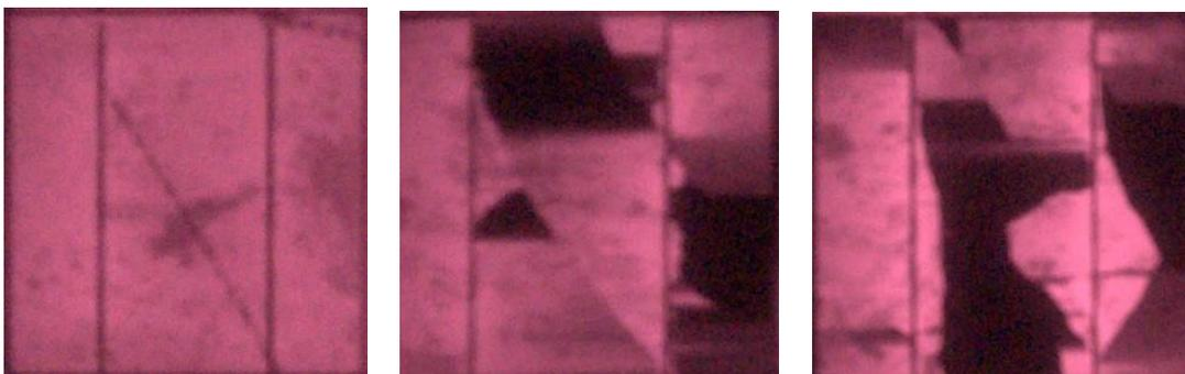
Figura 3-18. Celle affette da crack dovuti a stress meccanici.
