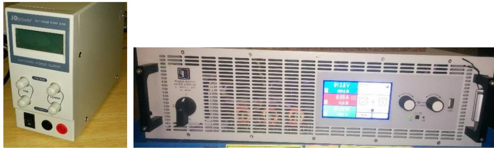
Figura 3-11. Alimentatori di diverse taglie in funzione del carico da alimentare.
