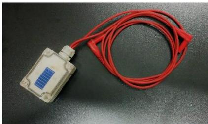
Figura 3-4. Cella solare tarata utilizzata per la misura dell'irradianza.
