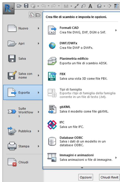
Figura 11 – Esportazione tramite file di scambio (Revit)
