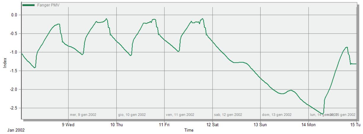
Figura 65 - Profili del PMV di una zona con pannello radiante sovrastante (piano terra)
