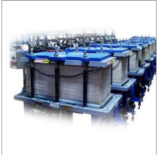
Figura 3-4: Sistema di Elettrodialisi per trattamento delle acque
