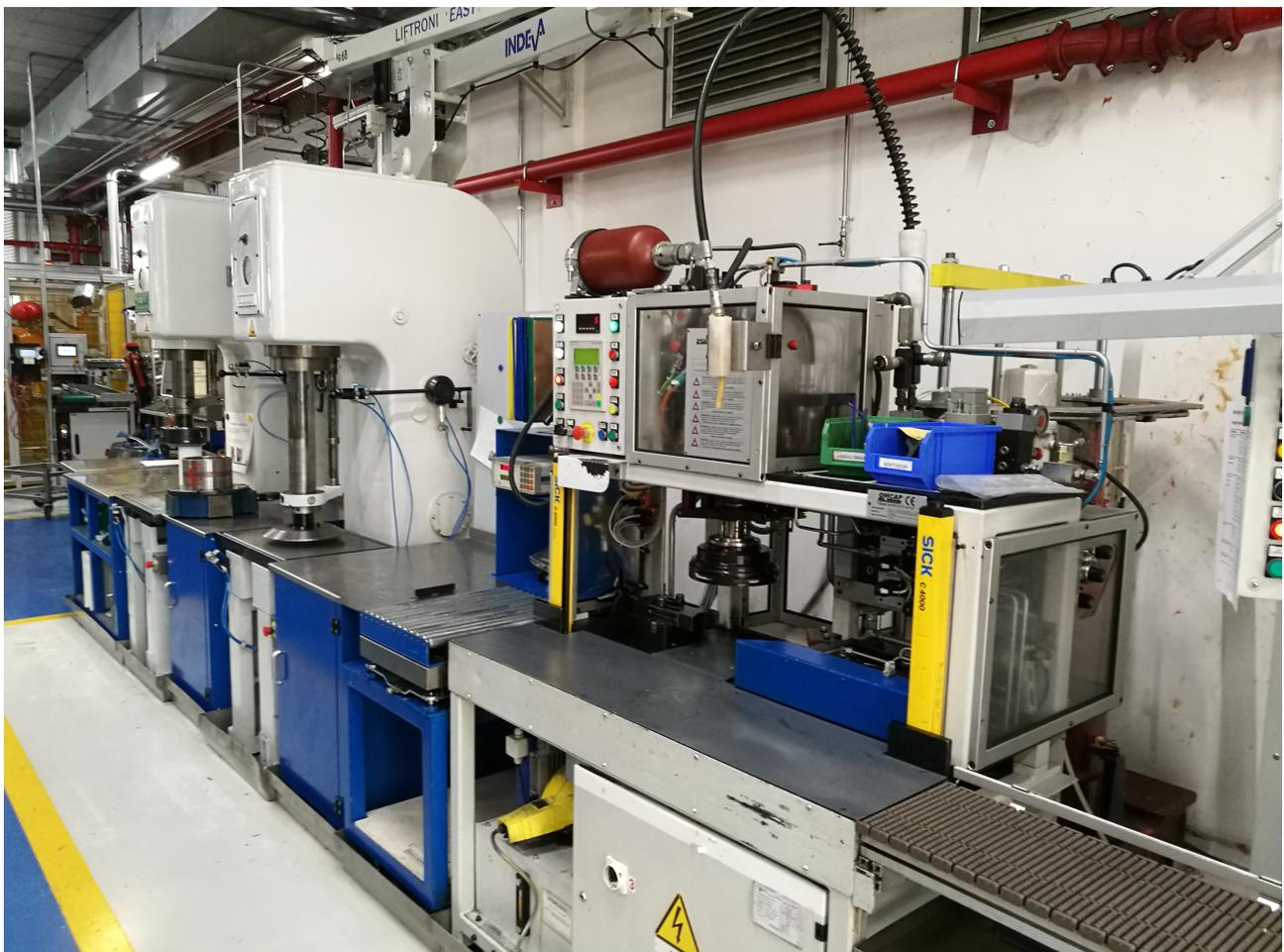
Figura 18 – stazione di ingrassaggio della TBU.
