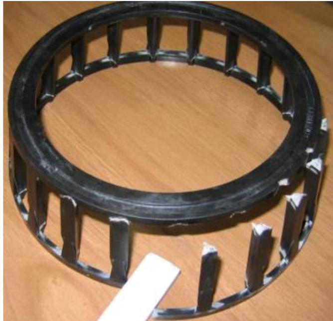
Figura 36 – rottura dei tenoni della gabbia polimerica.
