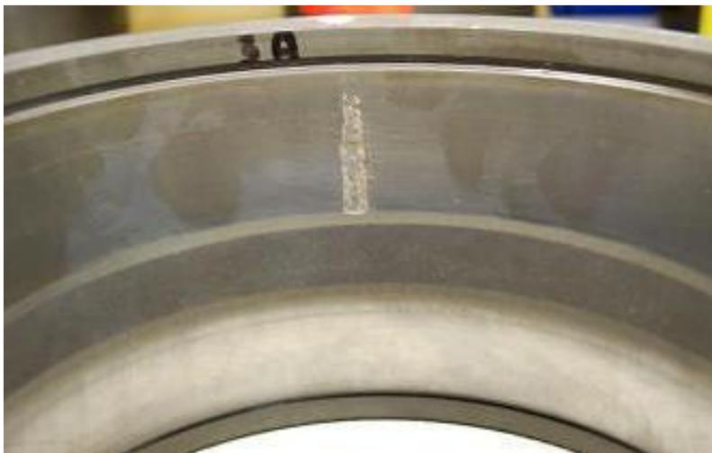
Figura 28 – Flaking sulla sede di rotolamento di un anello interno a causa di un cattivo montaggio del roller-set.
