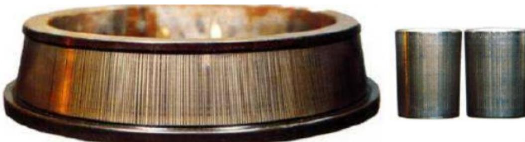
Figura 35 – scanalature per corrosione elettrica.
