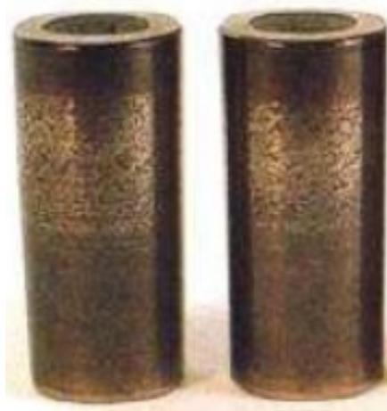
Figura 32 – indentatura da particelle contenute nel lubrificante.
