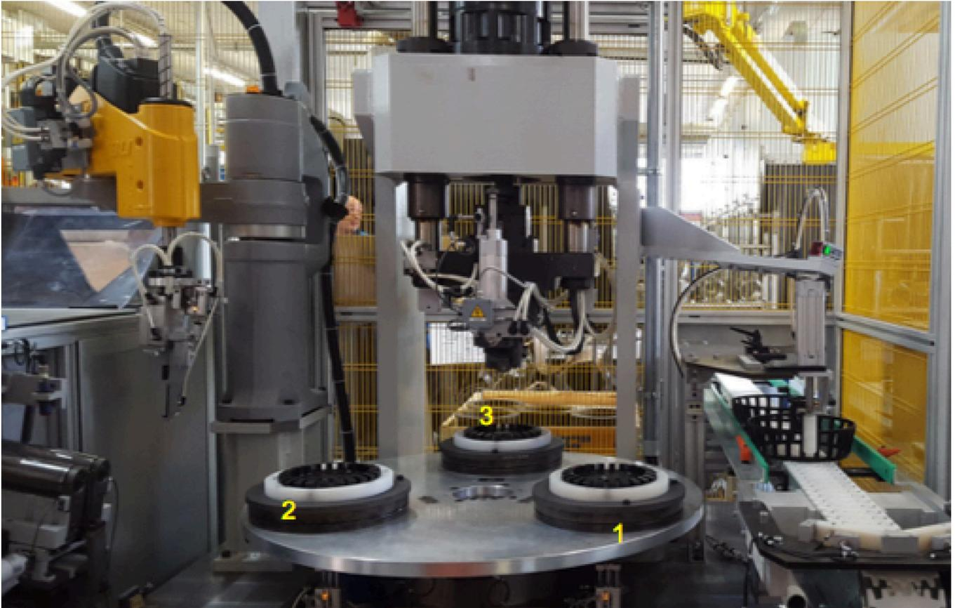
Figura 13 – 1 posizione dove viene depositata la gabbia orientata, 2 posizione dove una pinza robot inserisce i rulli nella gabbia e successivamente l'anello interno infine nella posizione 3 viene assemblato il roller-set grazie a una pressa.
