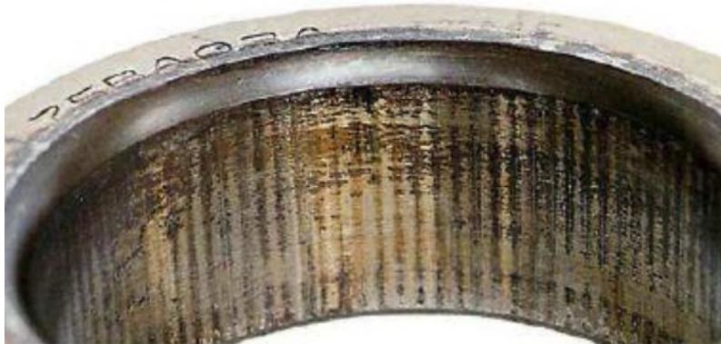
Figura 31 – fretting causato dal calettamento sul fusello.
