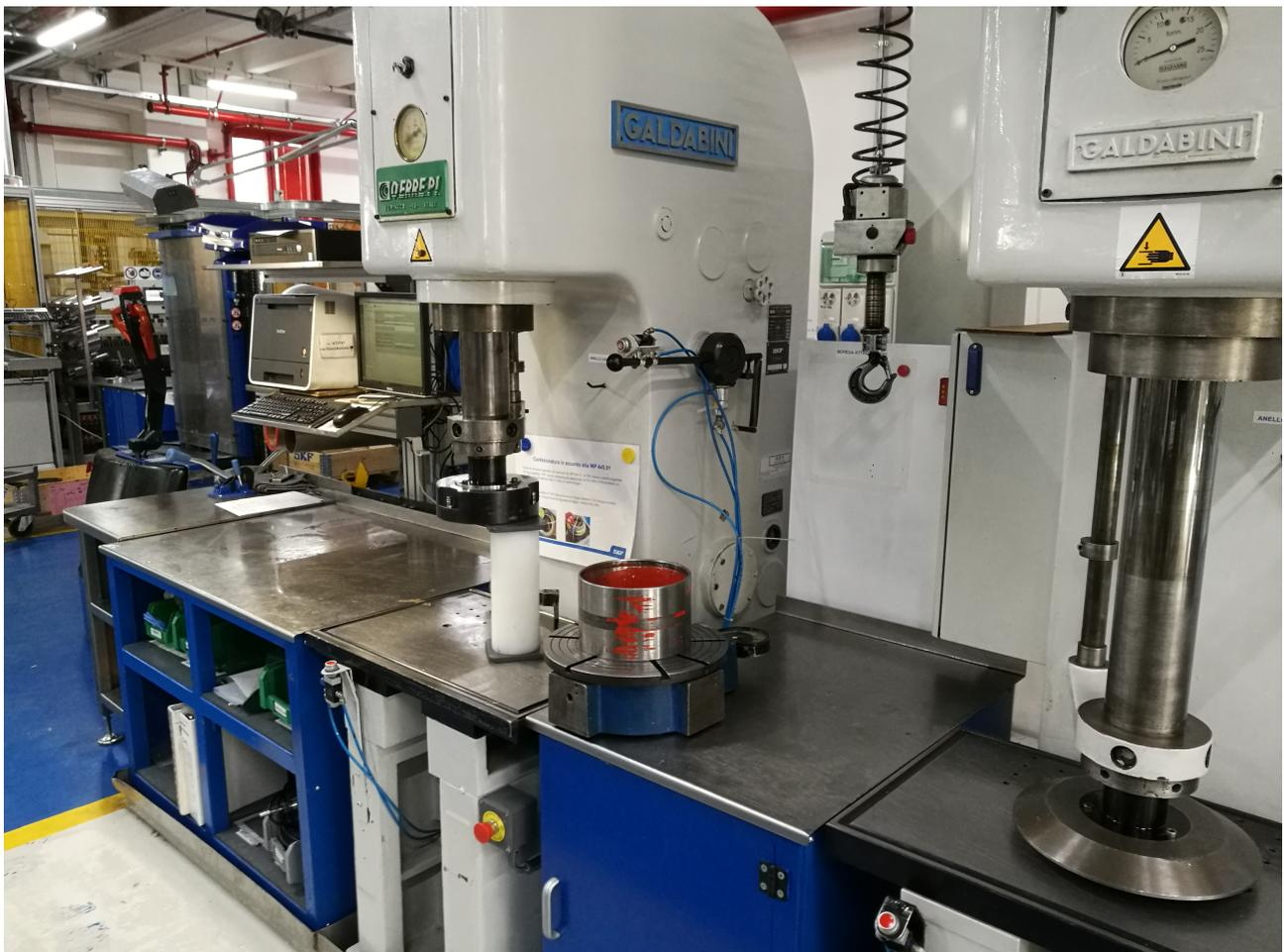
Figura 19 – ultima parte della linea manuale dove sono presenti le campane per assemblare il seal.
