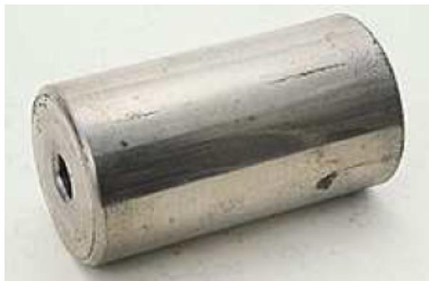
Figura 30 – spalling sul rullo a causa di un errato montaggio.
