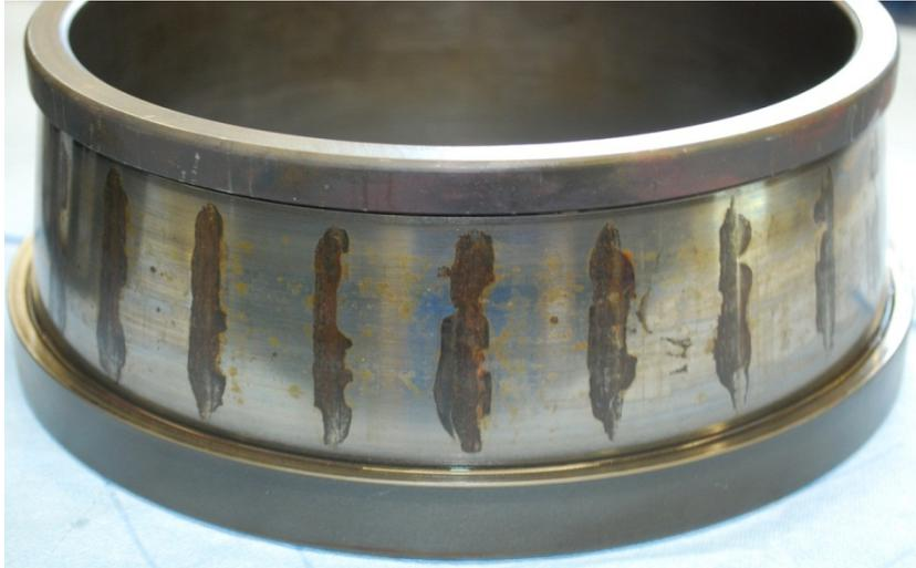
Figura 26 – corrosione della sede di rotolamento dell’anello interno causato dalla presenza di acqua nel lubrificante.
