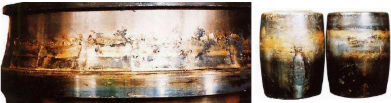
Figura 33 – grippaggio per mancanza di lubrificazione.
