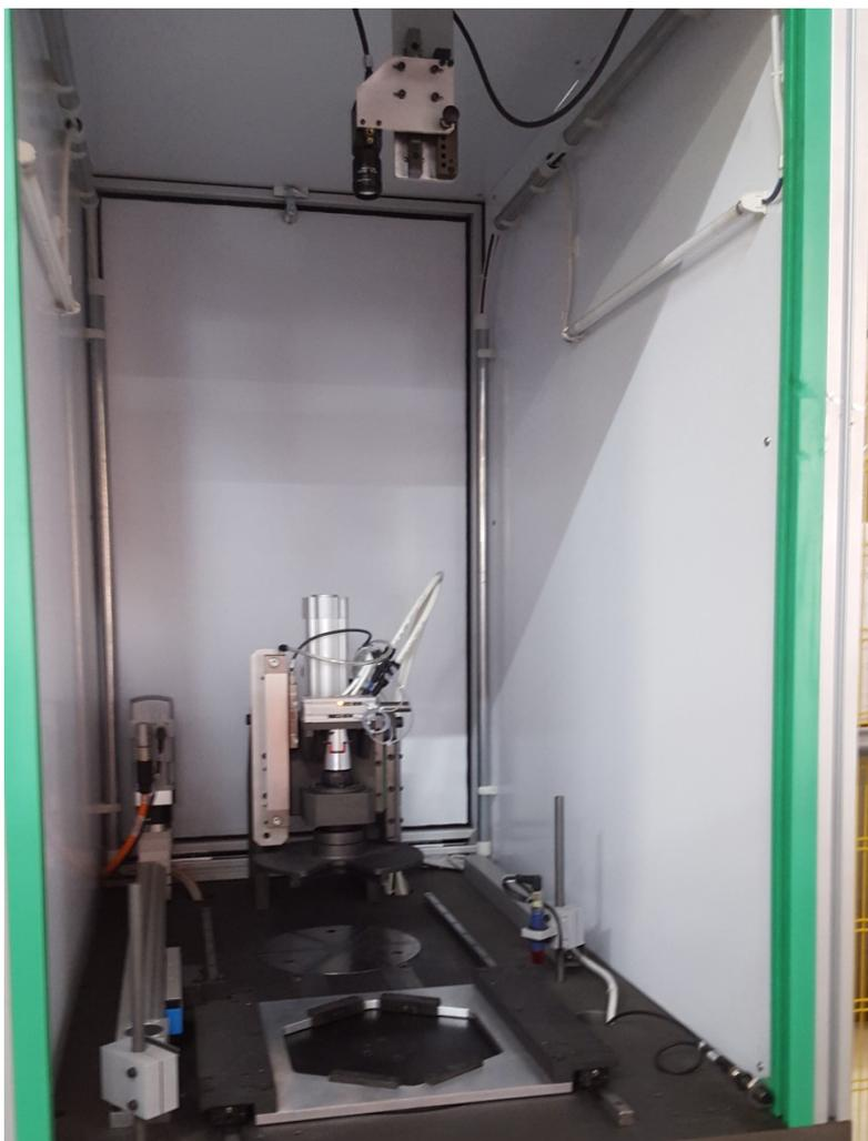
Figura 11 – Stazione per la misurazione dello spessore anello interno e lettura marcatura.
