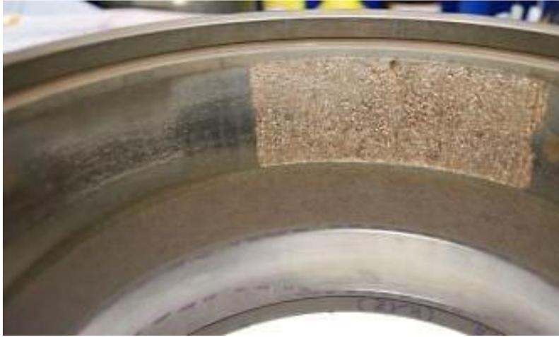
Figura 27 – Flaking sulla sede di rotolamento di un anello interno a causa di un carico assiale eccessivo.
