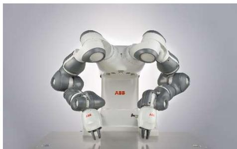
Figura 1.3: Esempio di Robot Collaborativo ABB. Fonte: <http://new.abb.com/products/robotics/it/robot-industriali/yumi>
