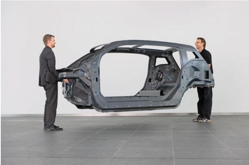
Figura 33: Telaio ultraleggero di BMW i3
