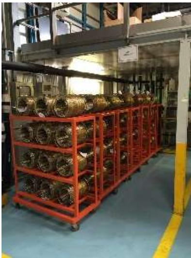
*Figura 61 – Corsia FIFO realizzata con il progetto pilota*
