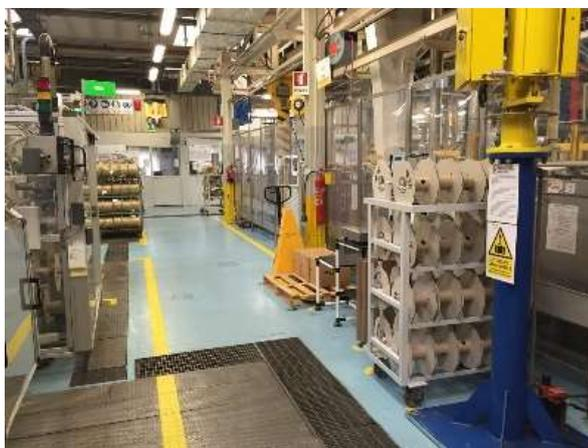
Figura 62 – Bobine a raggi corti per il prodotto finito in uscita dal Plating
