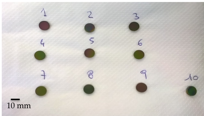
Fig. 4.2: Campioni di Ti6Al4V dopo il trattamento chimico (MimeTi).
