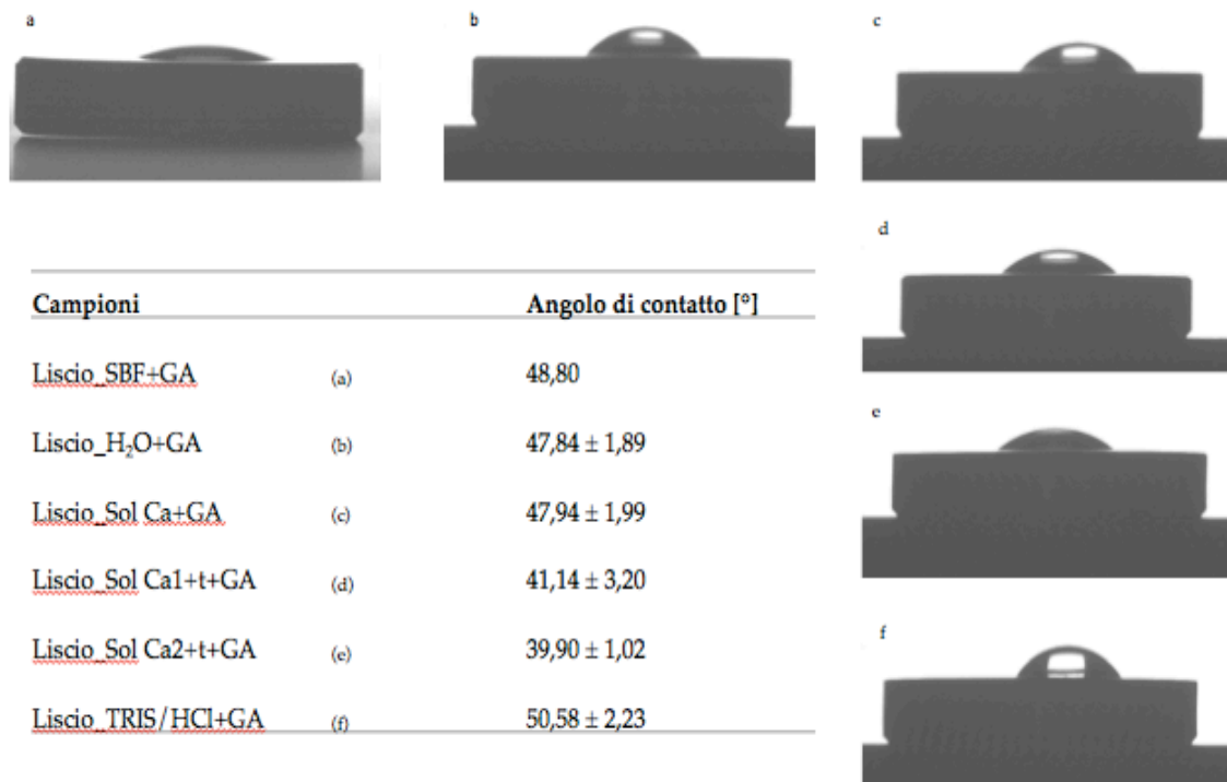
Fig. 5.7: Tabella con angoli di contatto di Ti6Al4V liscio funzionalizzato e relative immagini: a) Liscio_SBF+GA ; b) Liscio_H 2 O+GA ; c) Liscio_Sol. Ca+GA ; d) Liscio_Sol. Ca1+t+GA ; e) Liscio_Sol. Ca2+t+GA ; f) Liscio_TRIS/HCl+GA .
