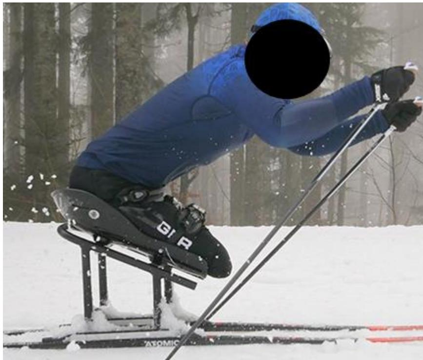
*Figura 8- Esempio di sit-ski con inclinazione di seduta di tipo kneeing*
