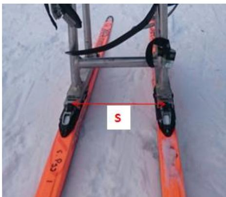
Figura 87. Posizioni degli sci nel modello originario dello slittino
