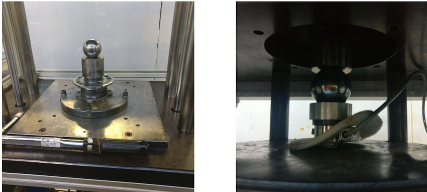
Figura 7.1. Montaggio del cuscinetto sulla PCA
