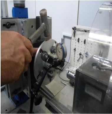
Figura 3.1. Posizionamento del cuscinetto e centraggio della flangia
