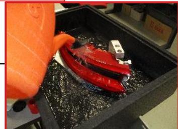
Figura 4.18 - Test di shock termico sui 2 diversi tipi di PMMA
