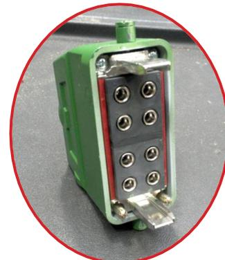
Figura 4.15 - SMED: connessioni elettriche ad attacco rapido
