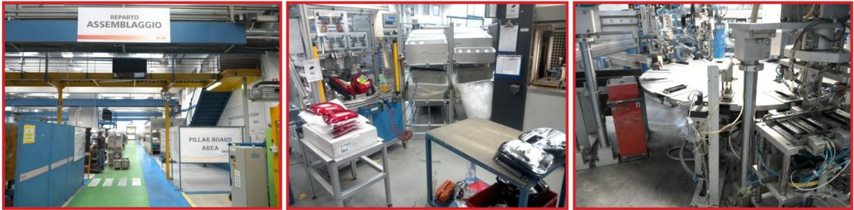
Figura 1.12 - Da sinistra: reparto Assemblaggio, postazioni a manodopera necessaria, macchina a elevata automazione.
