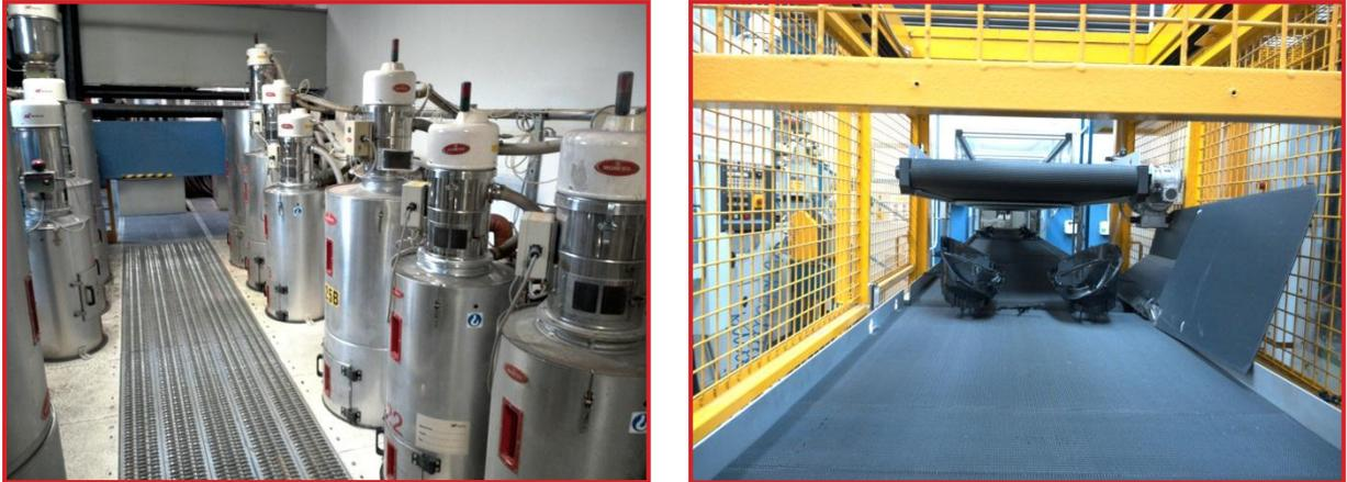
Figura 1.9 - Sinistra: forni Moretto magazzino materie prime. Destra: nastro trasportatore collegante la metallizzazione.
