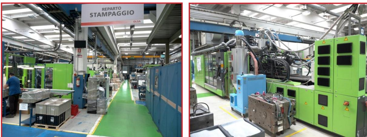
Figura 1.8- Sinistra: Reparto stampaggio. Destra: pressa 1500 t Engel con forno Moretto a bordo macchina.
