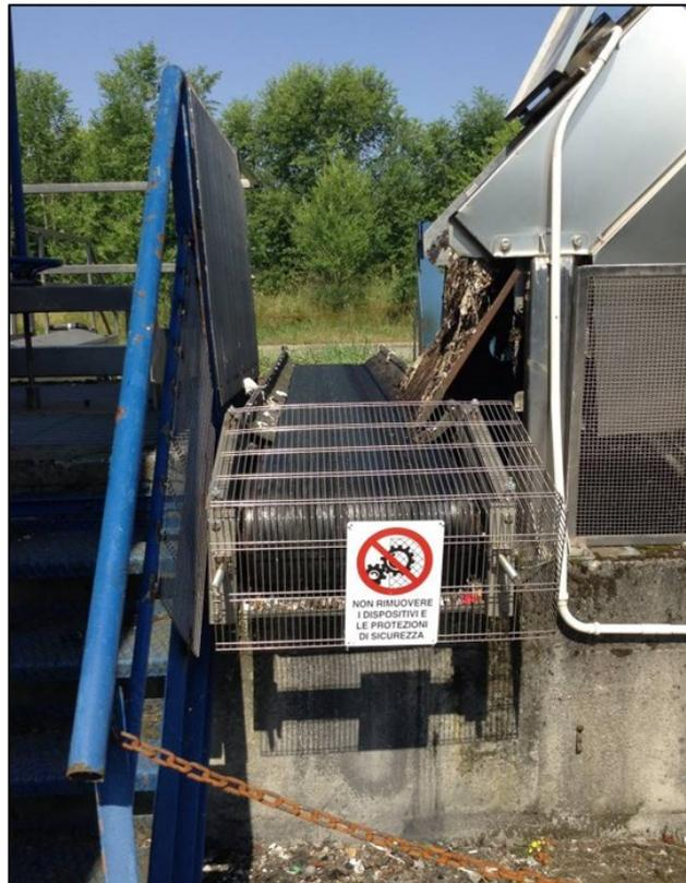
*Figura 30: Nastro trasportatore dopo gli interventi di mitigazione.*
