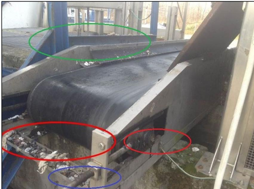
*Figura 28: Identificazione dei pericoli del nastro trasportatore.*
