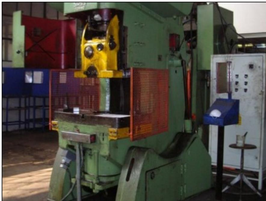
*Figura 15: Pressa meccanica in cui sono stati installati dei ripari<sup>35</sup>.*
