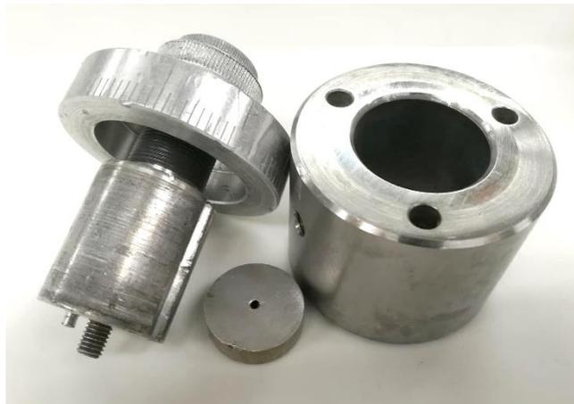
*Figura 4.1.1: Supporto per la lucidatura a facce piane e parallele*
