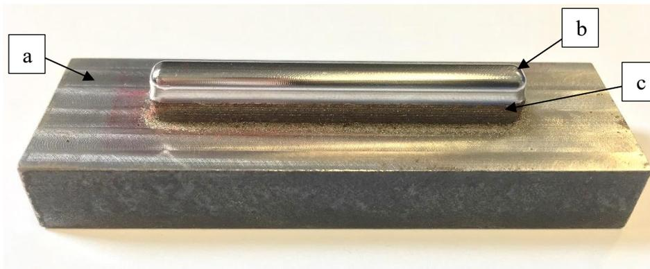
*Figura 1.2.1: Provino in analisi composto da a) substrato b) materiale depositato e poi rifinito per asportazione di truciolo c) materiale depositato e non rifinito.*
