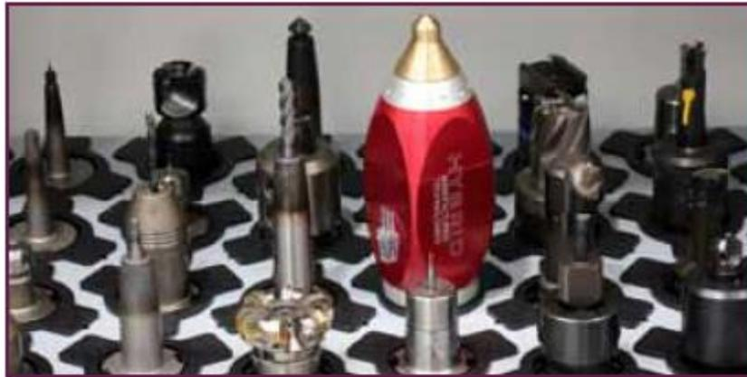
*Figura 1.1.3: Magazzino utensili di una macchina CNC*
