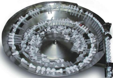
*Figura 1.3.1: Tazza vibrante per l'alimentazione di linee di produzione*
