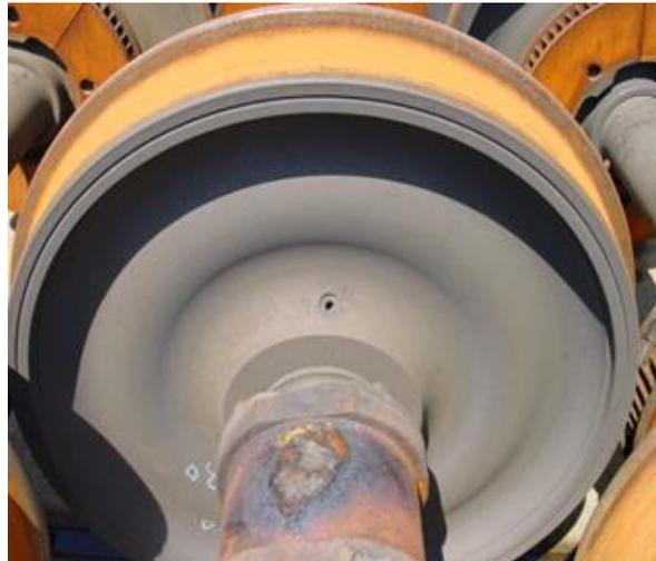
Figura 2.16 - Particolare del foro di immissione dell'olio per lo scalettamento della ruota monoblocco
