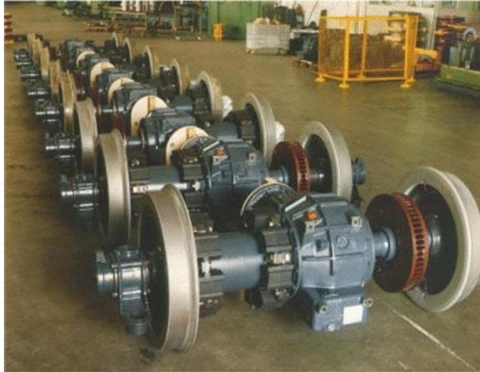
**Figura 2.2 - Rodiggio di un mezzo di trazione Diesel**
