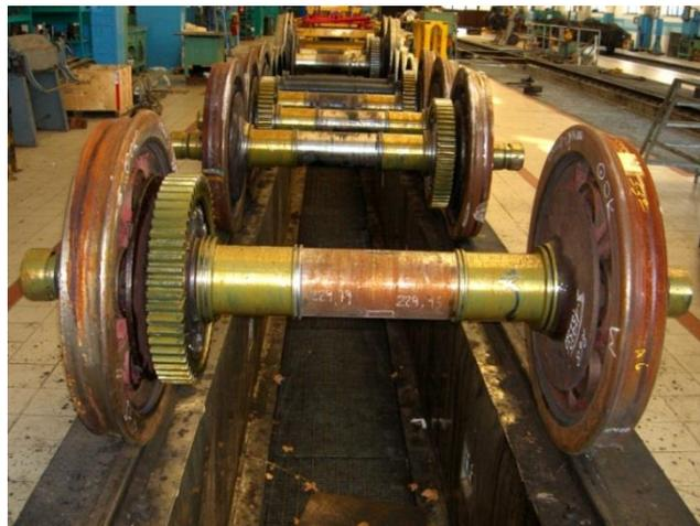
Figura 2.1 - Rodiggio di un mezzo di trazione elettrico
