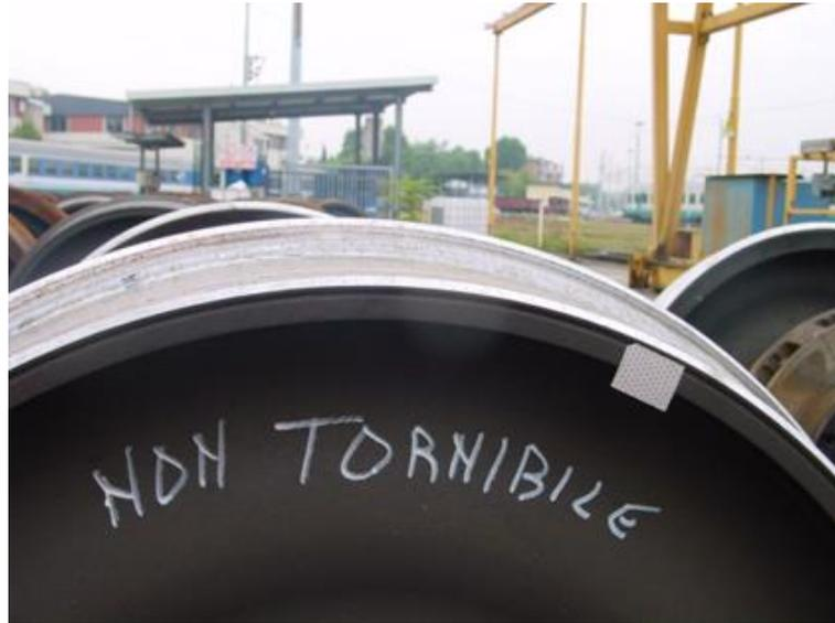
Figura 2.13 - Ruota non tornibile
