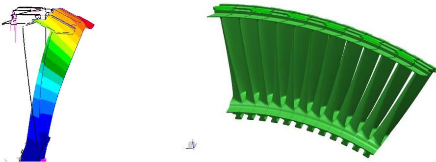
Figura 6.9. (a sinistra) Rappresentazione grafica della forma modale *flessionale* per la pala *Mistuned*, (a destra) schiera di palette per la configurazione *Mistuned*.
