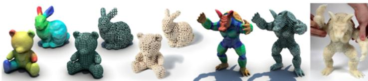
Figura 2.16: esempi con riempimento differente
