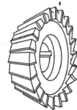
Figura 1.33: Fresa piano-conica, [1].
