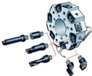
Figura 2.2: Magazzino a torretta, [3].
