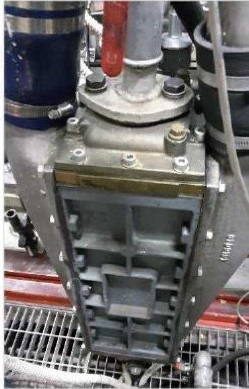
Figura 22: Intercooler dopo compressore
