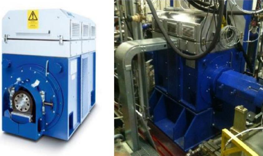
Figura 19: Freno dinamometrico
