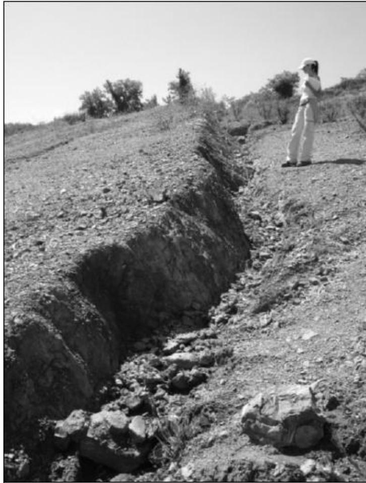
Figura 3.3.13 - Frattura in contropendenza. Il rigetto di circa 80 cm è stato raggiunto in circa due anni (Coli, 2010).
