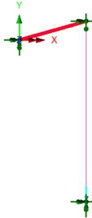
**Figura 4.13:** Modello Lusas: asta avente  $\lambda=200$  -  $h/d=0,28$  -  $e=L/1000$  e cavo di collegamento al martinetto
