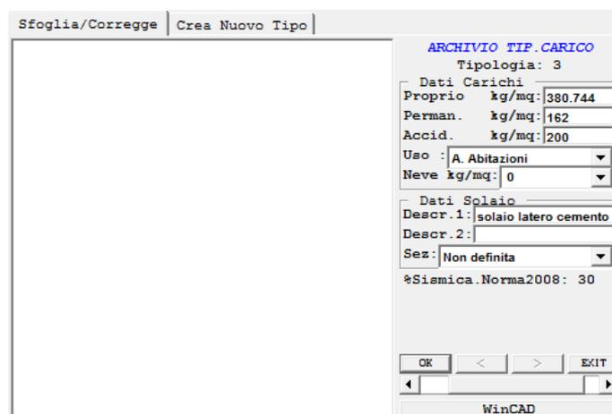
*Figura 5.4 Interfaccia per l'inserimento dei carichi di solaio all'interno del software di calcolo C.D.S.*
