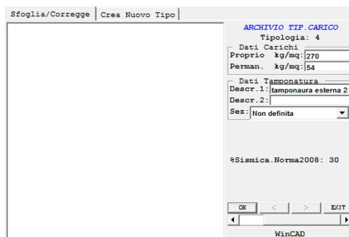
*Figura 5.5 Interfaccia per l'inserimento dei carichi di tamponatura all'interno del software di calcolo C.D.S.*
