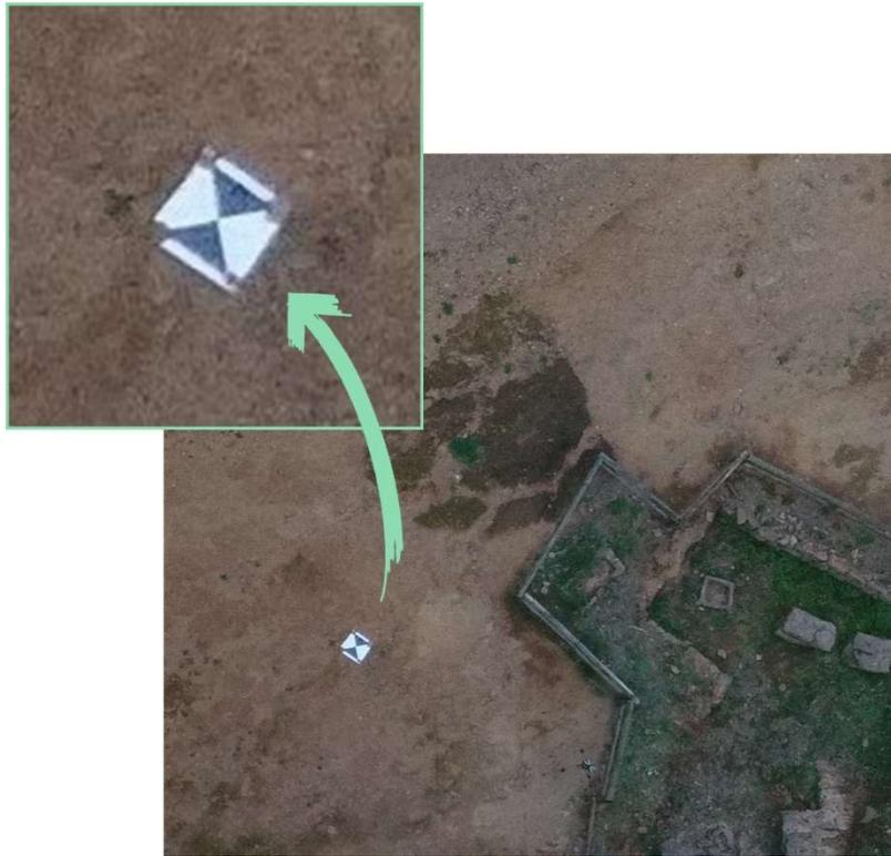
Figura 38 Esempio di target ad alta visibilità
