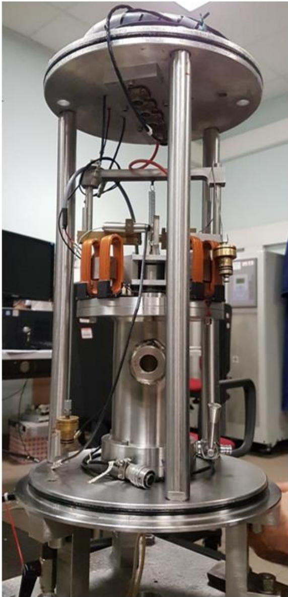
Figura 3.8. Apparecchiatura di colonna risonante presente nel laboratorio geotecnico del Politecnico di Torino.
