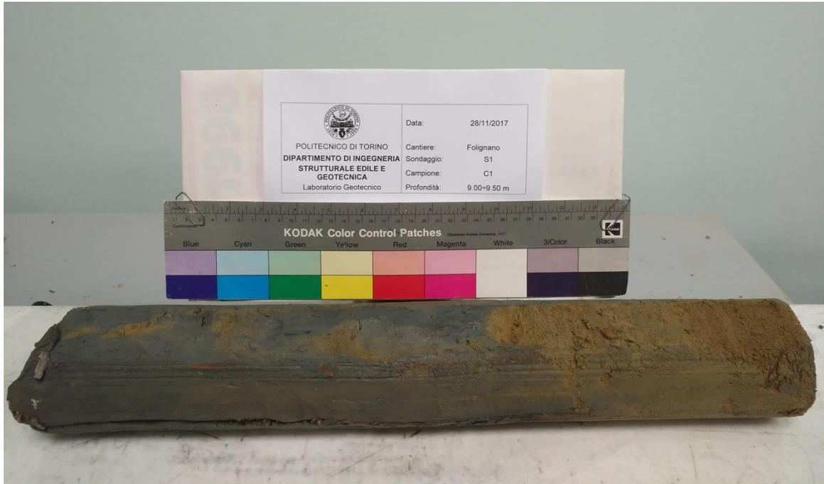
Figura 2.2. Campione 1 relativo al sondaggio S1 eseguito nel comune di Folignano (AP).
