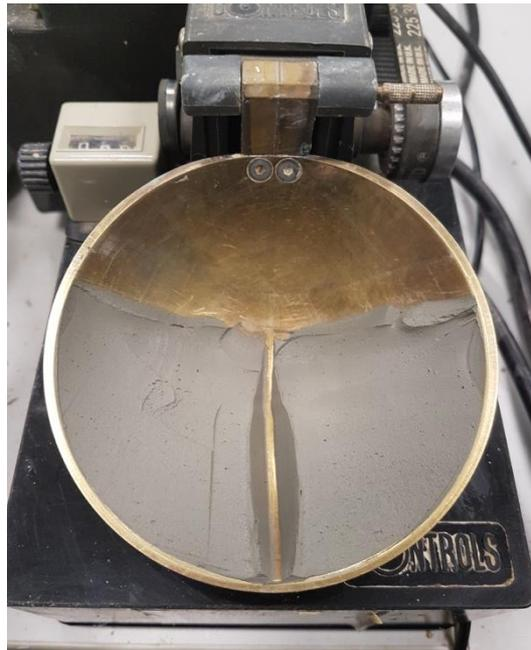
Figura 2.6. Sistemazione del terreno all'interno del cucchiaino di Casagrande e realizzazione del solco.
