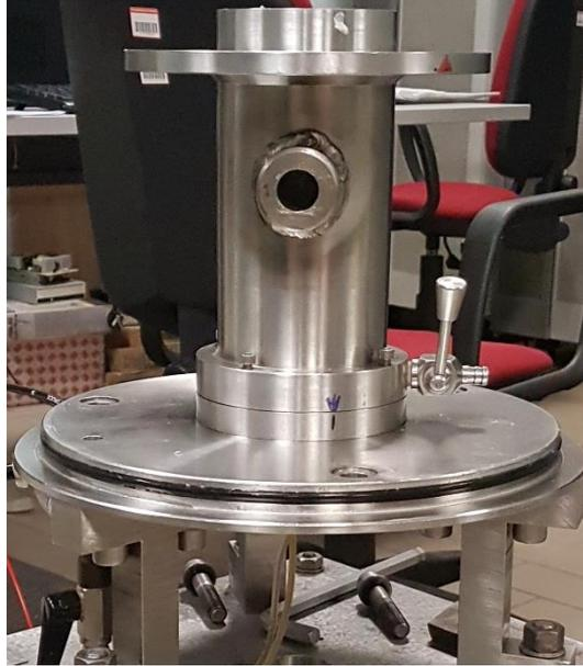
Figura 3.5. Struttura di sostegno del sistema di sollecitazione.
