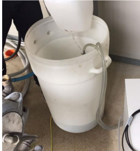
Figura 3.3: Recipiente utilizzato per la miscelazione del detergente con acqua deionizzata e \text{NaOH} per realizzare la soluzione lavante
