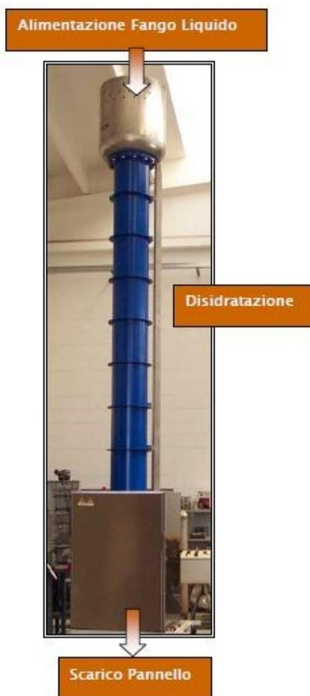
Figura 1. Schema del ciclo di disidratazione di StrizBox
