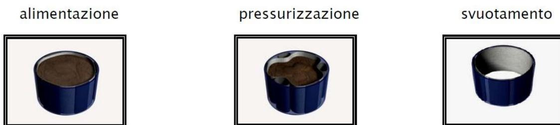
Figura 2. Rappresentazione delle fasi di un ciclo completo di StrizBox
