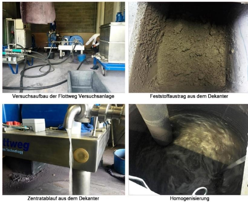
Figura 10. Fotografia del prodotto prima e durante una prova con decanter Flottweg. (Immagine fornita dall'Ing. Daniele Bruschi di Flottweg)
