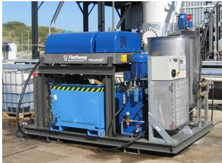
Figura 12. Decanter Flottweg installato con tutti i componenti ausiliari necessari (Immagine fornita dall'Ing. Daniele Bruschi di Flottweg)
