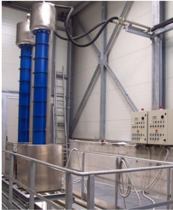
Figura 5. Fotografia di un modulo StrizBox installato in uno stabilimento industriale (<http://pumps-dewatering.com/tarua-pump/striz-box-membrane-filter-press/>)
