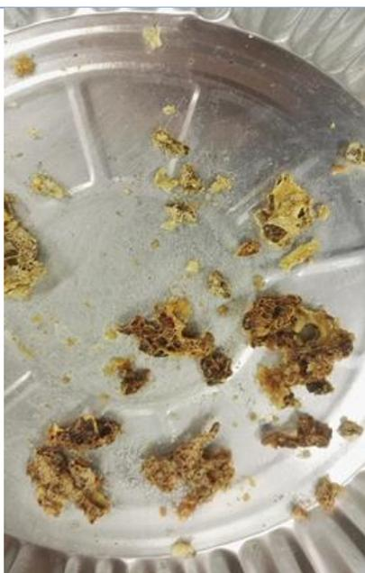
Figure 46 TV screen after heated aqua regia digestion
