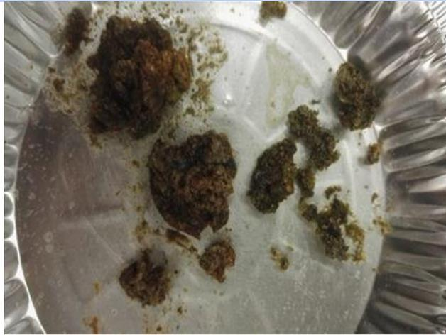
Figure 48 Laptops after heated aqua regia digestion
