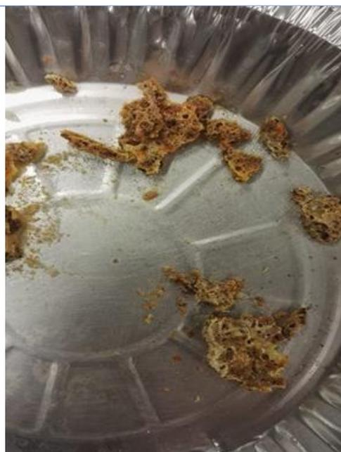
Figure 47 PC screen after heated aqua regia digestion
