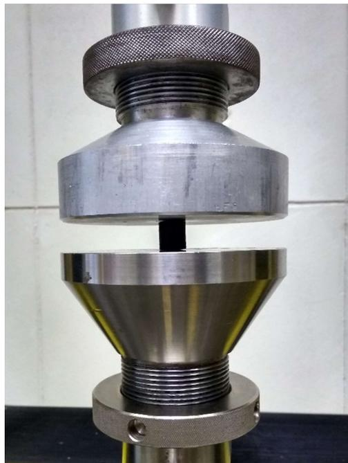
Figura 27- Prova a compressione del campione PEGDA (1% wt. PI) + PEDOT (5:1) + DMSO (5% wt.). La prova viene effettuata con una velocità di  $1 \text{ mm} \cdot \text{min}^{-1}$ , con un carico applicato da una cella da 500 N. È importante che le facce del provino siano parallele fra di loro, per permettere che la forza trasmessa sia correttamente distribuita in tutto il campione.
