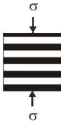
Figura 42 - Rappresentazione schematica ed ipotetica della disposizione delle fibre di PEDOT (in nero) all'interno della matrice di PEGDA (in bianco) rispetto al carico applicato durante la prova di compressione.
