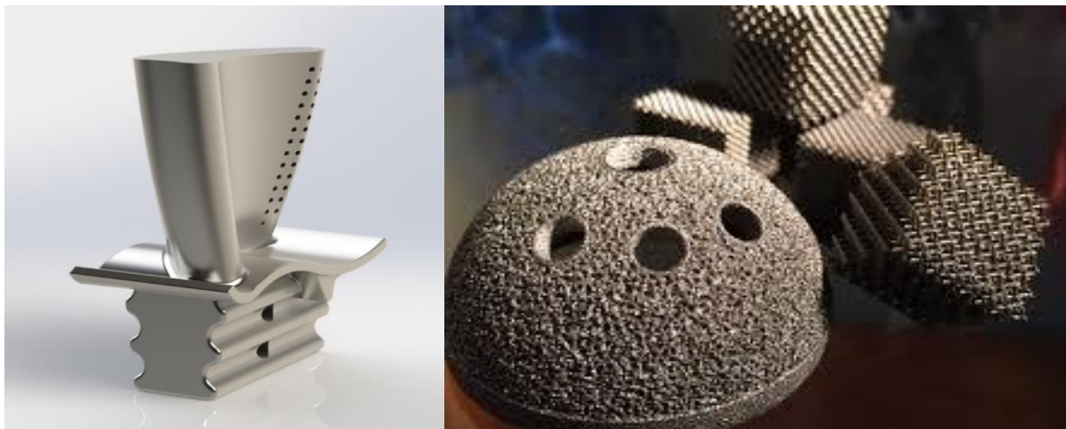
Figura 2.3 Palette di turbina in lega di titanio (grm-consulting.co.uk) e protesi in lega di titanio e cobalto (Fournier, 2016)
