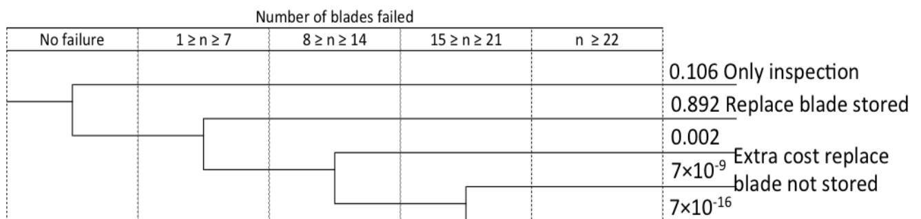
**Figure 2 -** Calcolo della probabilità di rottura attraverso IDDA (Opzione A)
