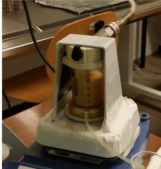
**Figura 3.6 - Cella usata per ultrafiltrare la soluzione proteica**
