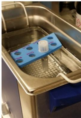
**Figura 3.8 - Bagnetto ad ultrasuoni**
