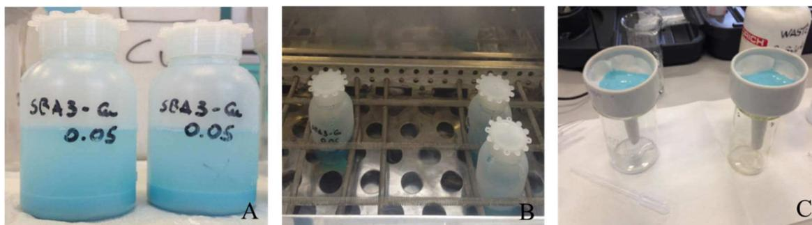
**Figura 5.3** Soluzione acquosa 0,05M di  $\text{Cu}(\text{CH}_3\text{COO})_2 \cdot 2\text{H}_2\text{O}$  e SBA3(A); soluzione acquosa di  $\text{Cu}(\text{CH}_3\text{COO})_2 \cdot 2\text{H}_2\text{O}$  e SBA3 in oscillatore termostatico (B); Filtrazione della soluzione acquosa di  $\text{Cu}(\text{CH}_3\text{COO})_2 \cdot 2\text{H}_2\text{O}$  e SBA3 dopo agitazione (C).
