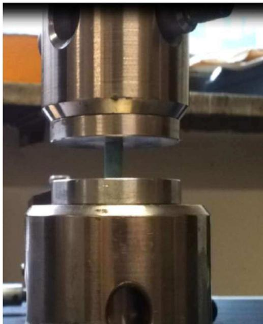
**Figura 5.15** Macchinario durante la prova di compressione [4].
