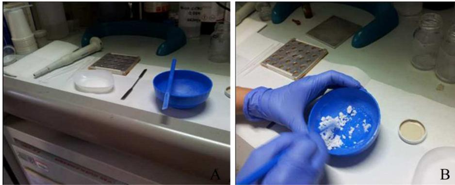
**Figura 5.7** Strumenti utilizzati per la preparazione del CEMEX RX (A); miscelazione dei componenti del CEMEX RX (B) [4].
