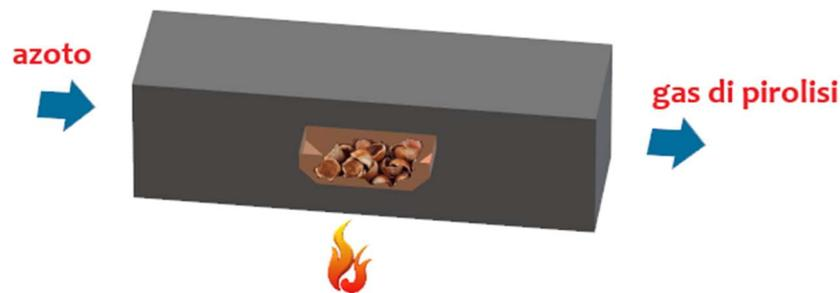
**Figura 3.2:** Schema del forno di carbonizzazione.
